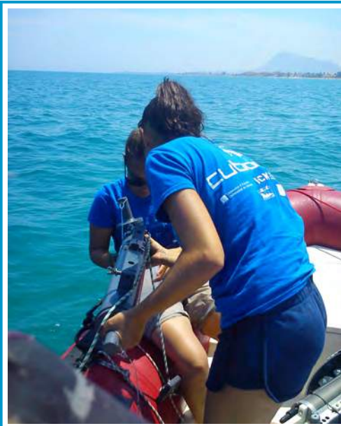
Figura 6. Muestreando agua con botella oceanográfica "Niskin".
